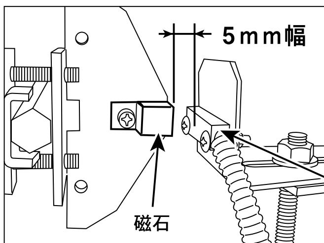
磁気センサーと磁石の間を 5 mm 幅で調整してください。
