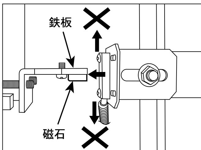
上から見たときに、磁気センサーの中心を磁石と鉄板の「合せ目」に合わせてください。
